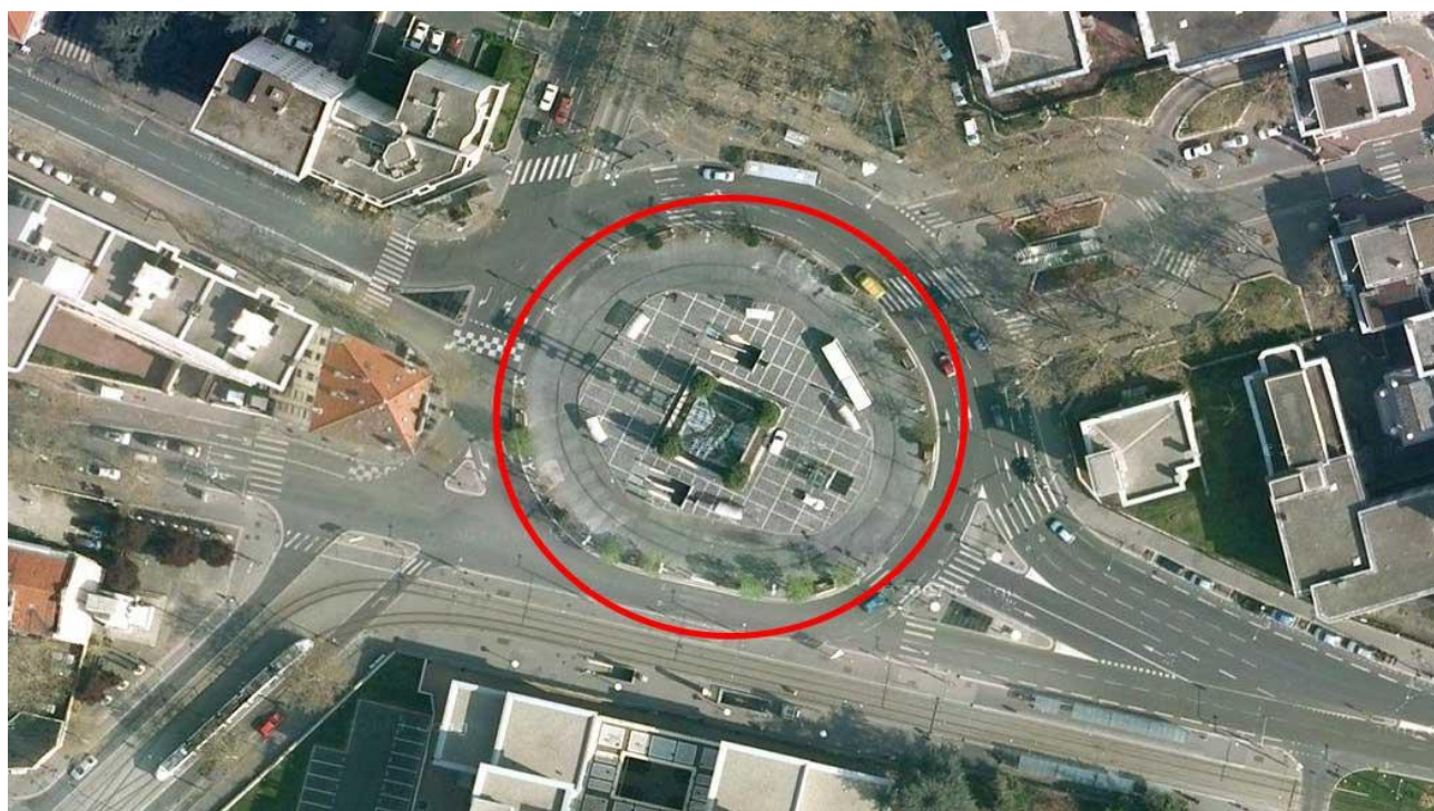
Рисунок 59 - Узел пересадки автобусных маршрутов в Лионе
